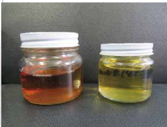
混合プラスチックごみを油化した燃料油 (左) と溶剤抽出法により不純物を除去した燃料油 (右)
